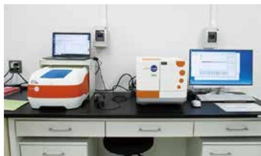
写真左 全自動ELISA装置Ella: 全自動で複数分析物を同時測定できる。90分以内に最大8項目を同時に分析し、データ取得まで行う。
